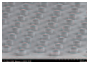
Cu pillar + solder bump plating Ø75 um
